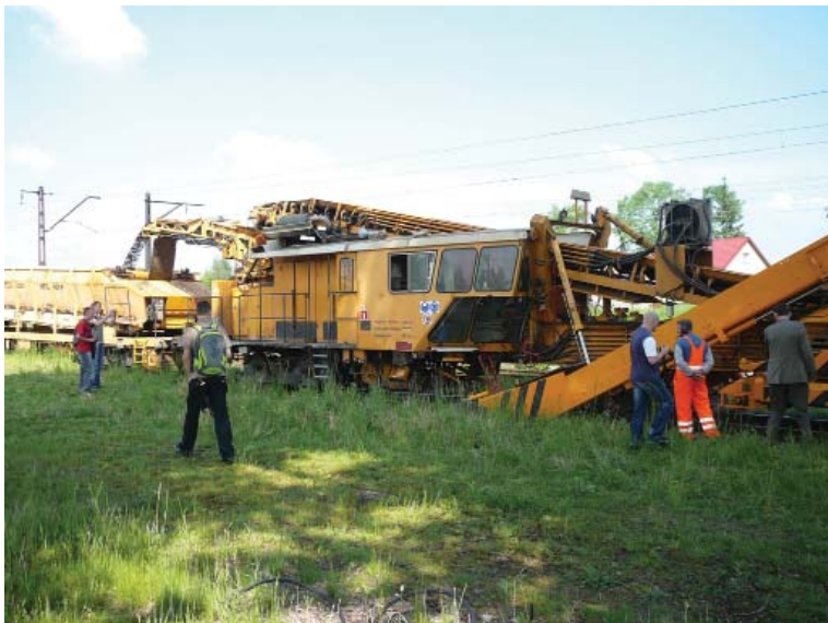
Zwiedzanie rozpoczęło się od oględzin prezentacji oczyszczania podsypki przy pomocy oczyszczarki RM80
