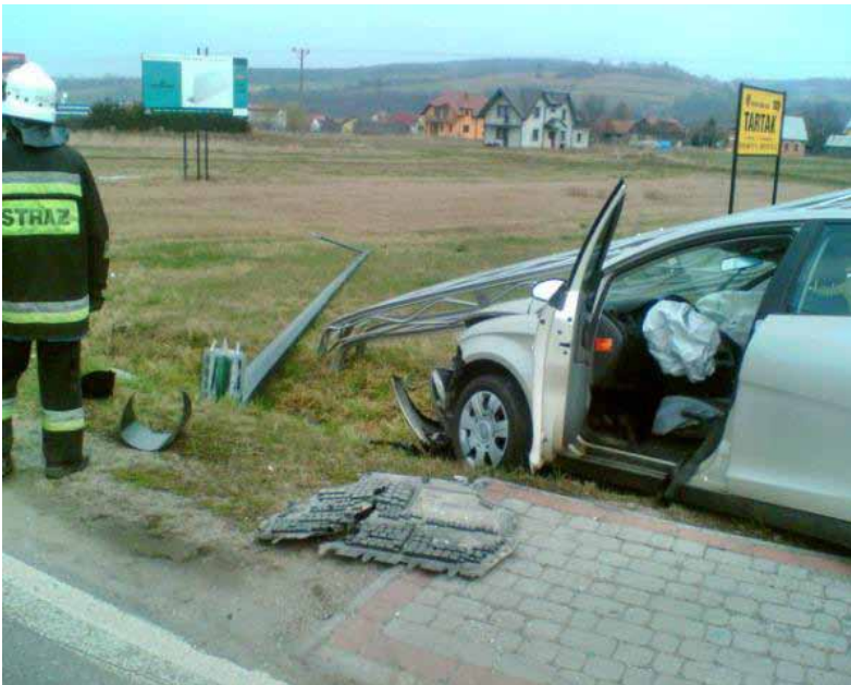
Fot. 14. Podatna konstrukcja wsporcza znaku D6 oraz podatny słup oświetleniowy nie spowodowały obrażeń kierowcy w czasie niezamierzonego zderzenia
