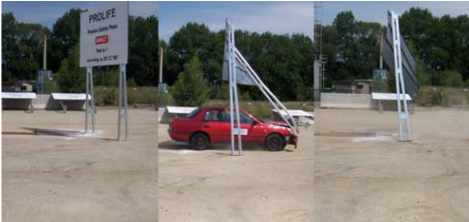
Fot. 5. Testy zderzeniowe pojazdu z konstrukcją wsporczą PROLIFE na zgodność z wymaganiami normy PN- EN 12767 ( Akredytowany Instytut DSD Austria)
