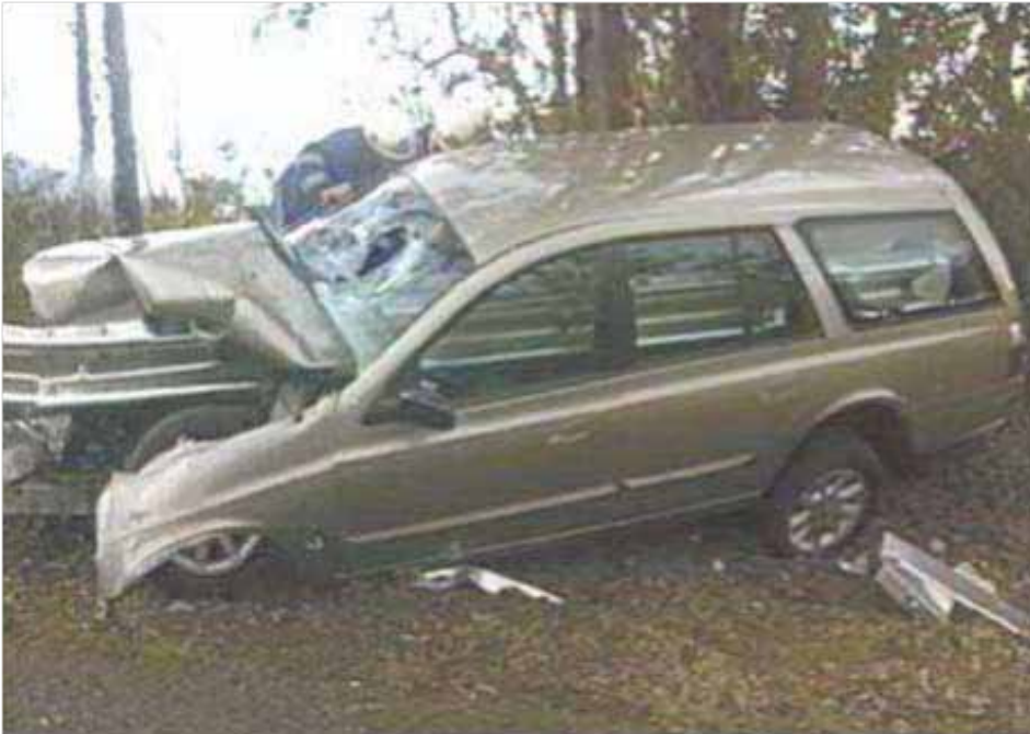
Fot. 2. Przypadki najechania pojazdów na powszechnie stosowane zakończenia początkowych odcinków drogowych barier ochronnych
