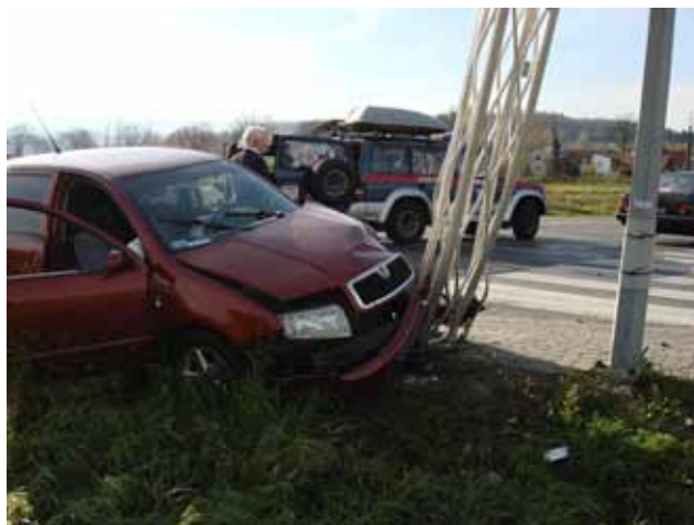
Fot. 12. Zderzenia z konstrukcjami bezpiecznymi spełniającymi wymagania normy PN EN 12767 dają szansę na uniknięcie tragicznych skutków wypadków
