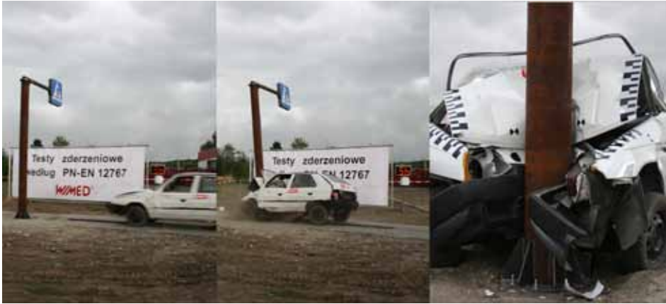
Fot. 13. Test zderzeniowy na torze WIMED - skutki zderzenia pojazdu ze sztywną konstrukcją przy prędkości 56 km/h
