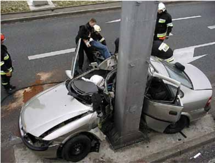
Fot. 9. Zderzenie ze sztywną konstrukcją wsporcą bramownicy nie dało szans przeżycia dla kierowcy i pasażera
