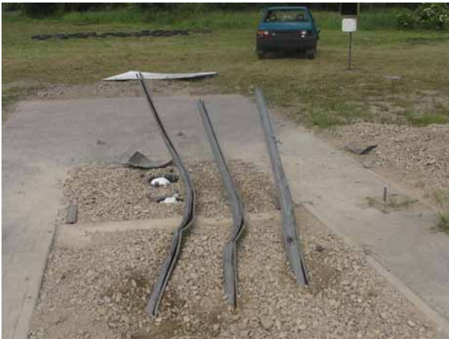
Fot. 6. Test zderzeniowy z słupkami bezpiecznymi PROLIFE (prywatny tor zderzeniowy WIMED) - podatność słupków w zderzeniach minimalizuje przeciążenia działające na kierowcę
